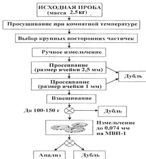
Рисунок 5.3. Схема обработки анализа проб почв [6]
