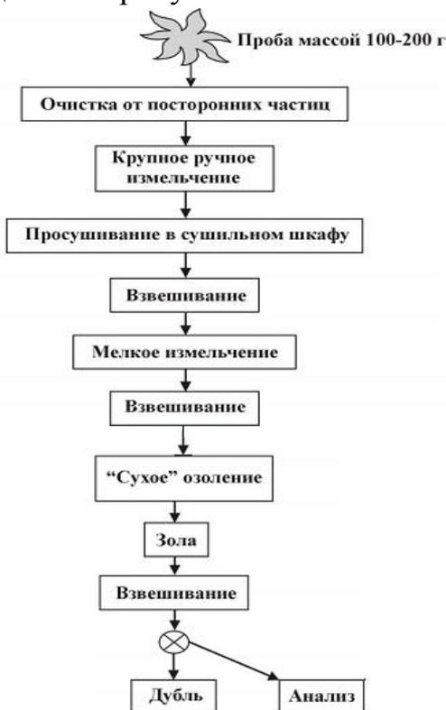
Рисунок 5.5– Схема обработки и изучения проб растительности [6]
