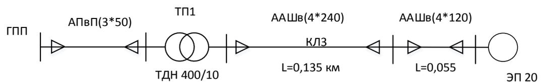
Рисунок 6. Радиальная схема для расчета отклонения напряжения
