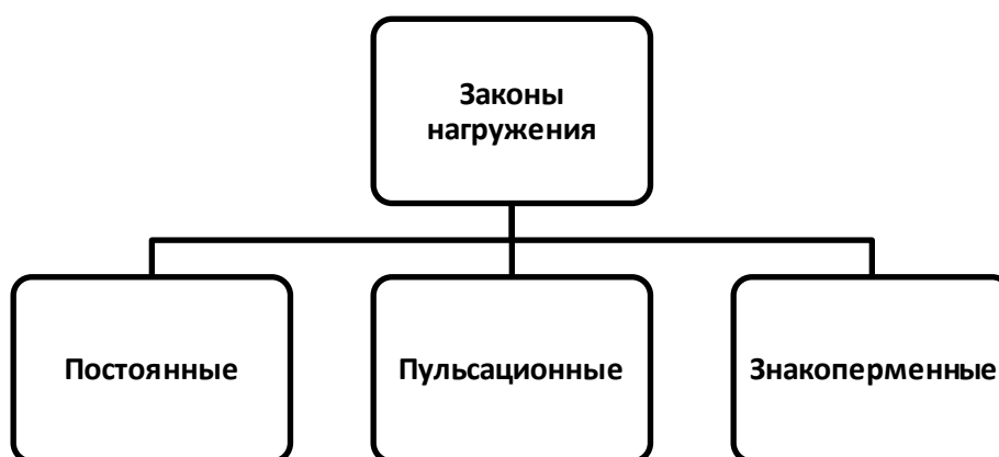
Рисунок 1.2. Классификация законов нагружения.
