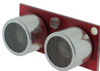
Рисунок 7 – Ультразвуковой датчик
