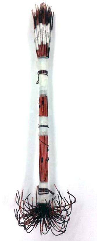
Рисунок 7 – Макет межвитковой изоляции всыпной обмотки асинхронного электродвигателя
