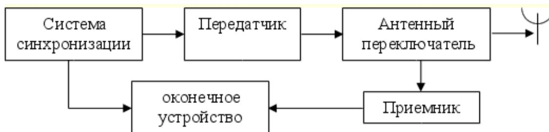
Рисунок 1.4 – Структурная схема импульсного метода
