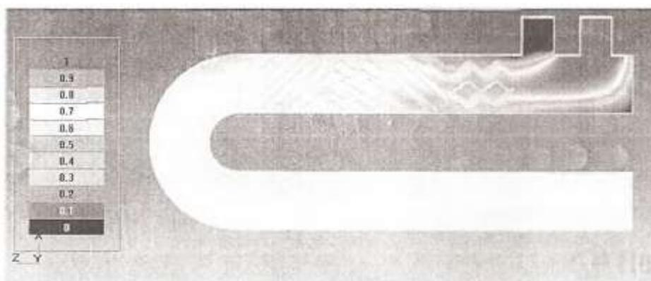
Рисунок 2.20 – Мольная доля бензола в продольном сечении устройства
