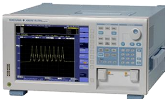
Рисунок 18 – Внешний вид оптического анализатора спектра Yokogawa AQ6370C
