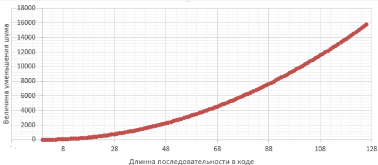
Рисунок 25 – Уменьшение шума при кодировании относительно длины последовательности в коде
