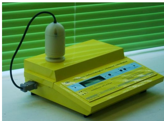
Рисунок 2.1 – Измеритель низкотемпературных показателей нефтепродуктов ИНПН «Кристалл»
