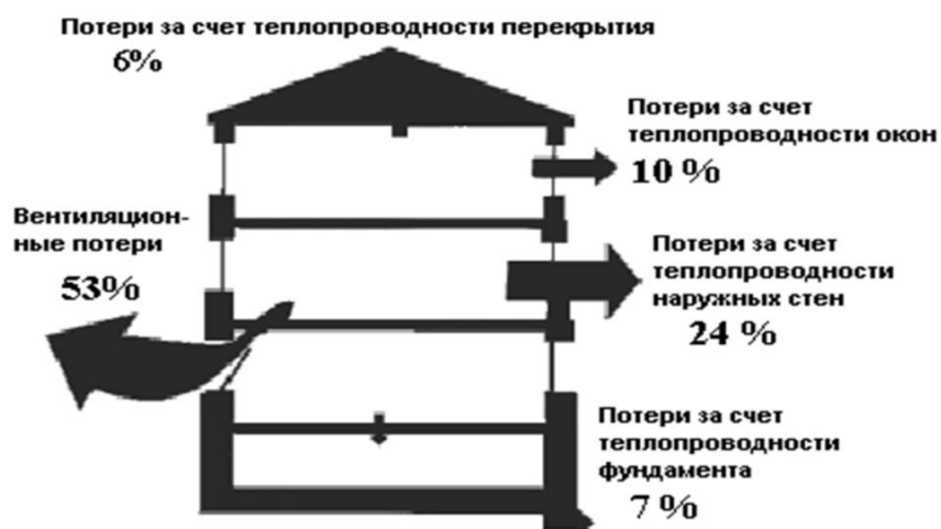
Рисунок 2.14 – Структура распределения тепловых потерь на объектах университета (через ограждающие конструкции)
