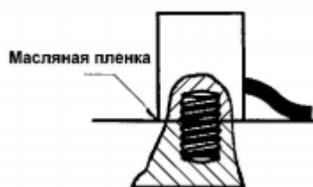
Рис. 7. Монтаж датчика вибрации
