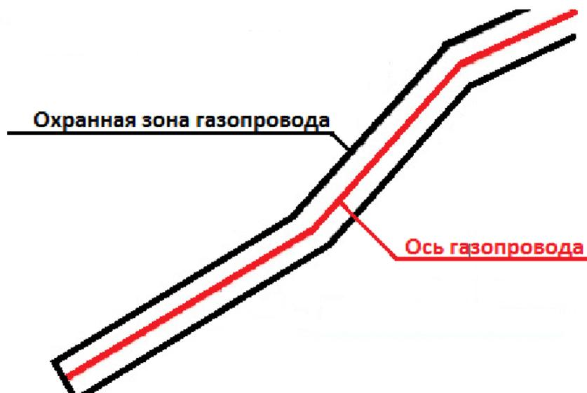
Рисунок 1 – Охранная зона газопровода.
