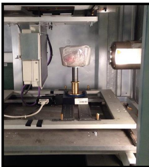
Рисунок 22 - Проведение эксперимента с помощью рентгеновского микротомографа «ОРЕЛ-МТ»
