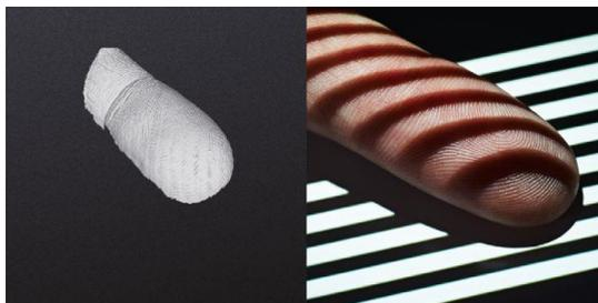
Рисунок 4 – Проекция световой сетки на объект (справа) и модель сканируемого объекта (слева). В качестве объекта представлен палец человека
