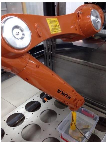
Рисунок 30 – Проведение эксперимента с помощью автоматизированной ультразвуковой системы томографического контроля
