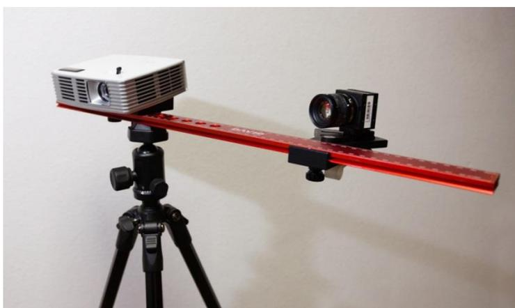
Рисунок 3 – Внешний вид 3D-сканера
