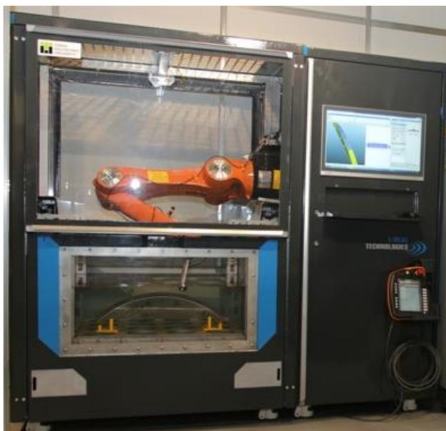
Рисунок 29 – Внешний вид автоматизированной ультразвуковой системы томографического контроля
