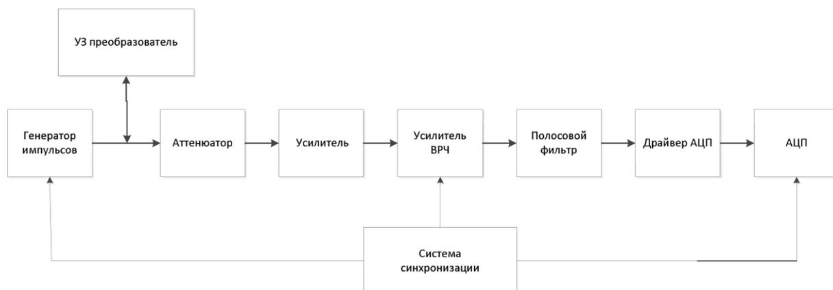
Рисунок 13 – Типовая структурная схема аналоговой части одноканальной системы ультразвукового контроля
