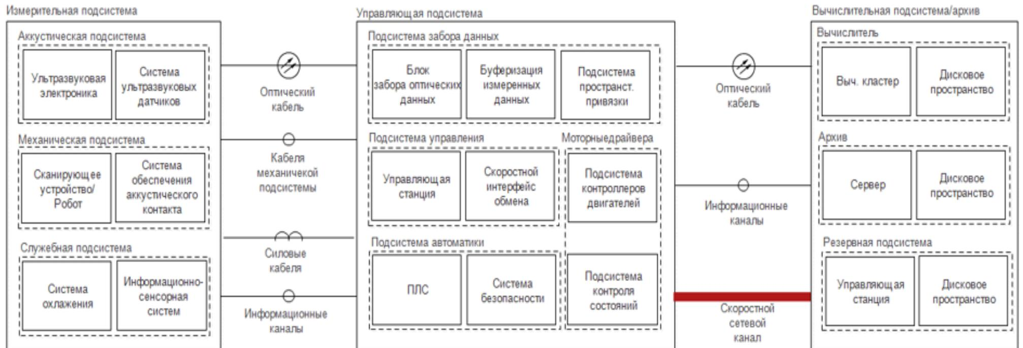
Рисунок 15 – Структурная схема макета автоматизированной ультразвуковой системы томографического контроля
