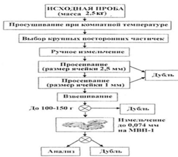
Рисунок 9 - Схема обработки и изучения проб почвы и донных отложений[4]
