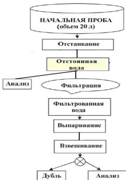
Рисунок 10 - Схема обработки и анализа водных проб [4]
