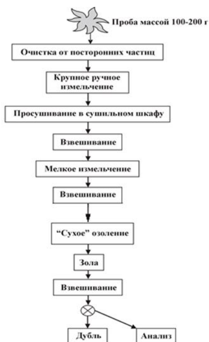
Рисунок 11 - Схема обработки и изучения проб растительности [4]
