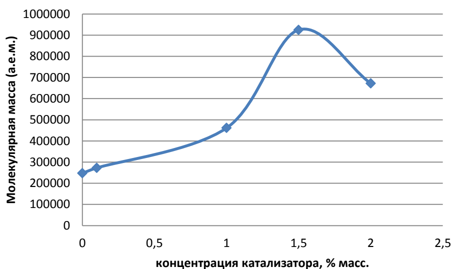
Рисунок 15 –Зависимость молекулярной массы полимера модифицированного этиленгликолем от концентрации катализатора (октоата олова)
