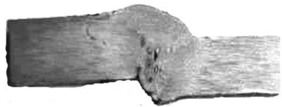
Рисунок 5.2 Разрез реального сварного шва с макро- и микродефектами.
