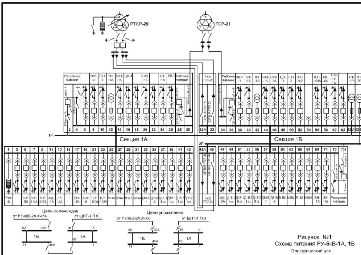
Рисунок 1.1 - Схема питания РУ-6кВ-1А, 1Б
