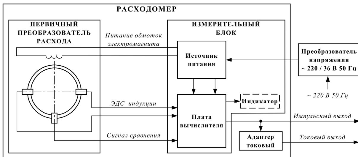
Рисунок 11 – Структурная схема расходомера–счетчика ВЗЛЕТ ЭРСВ
