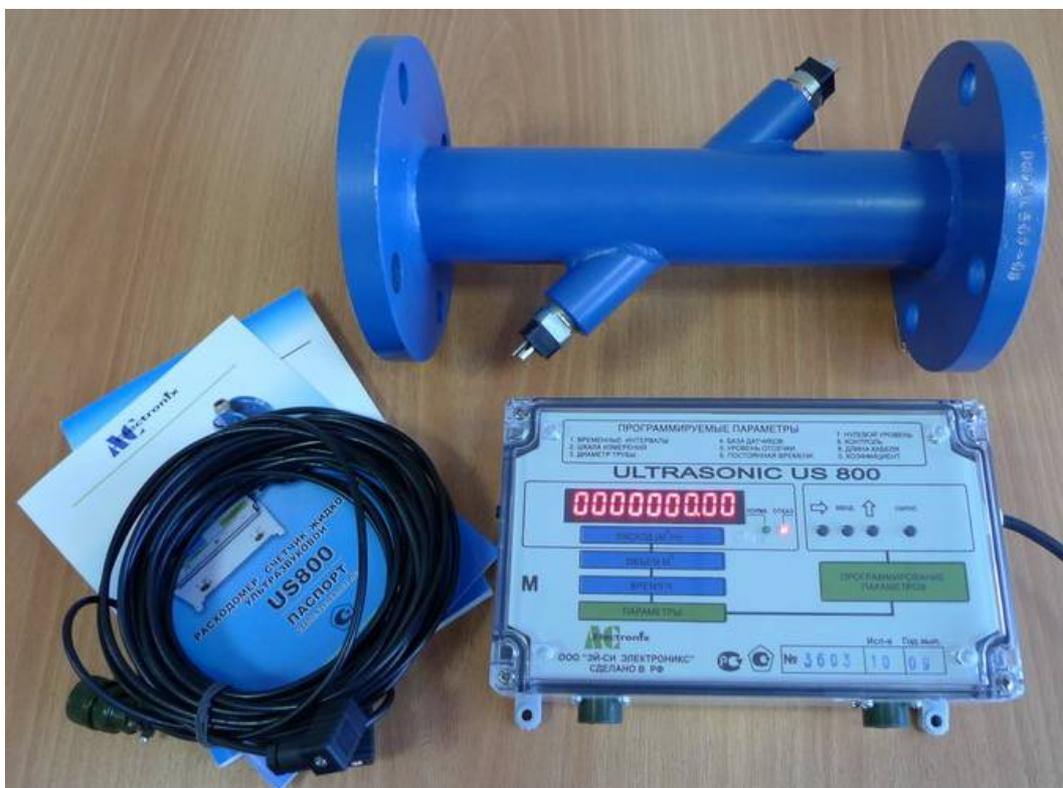
Рисунок 12 – Ультразвуковой расходомер Ultrasonic US 800
