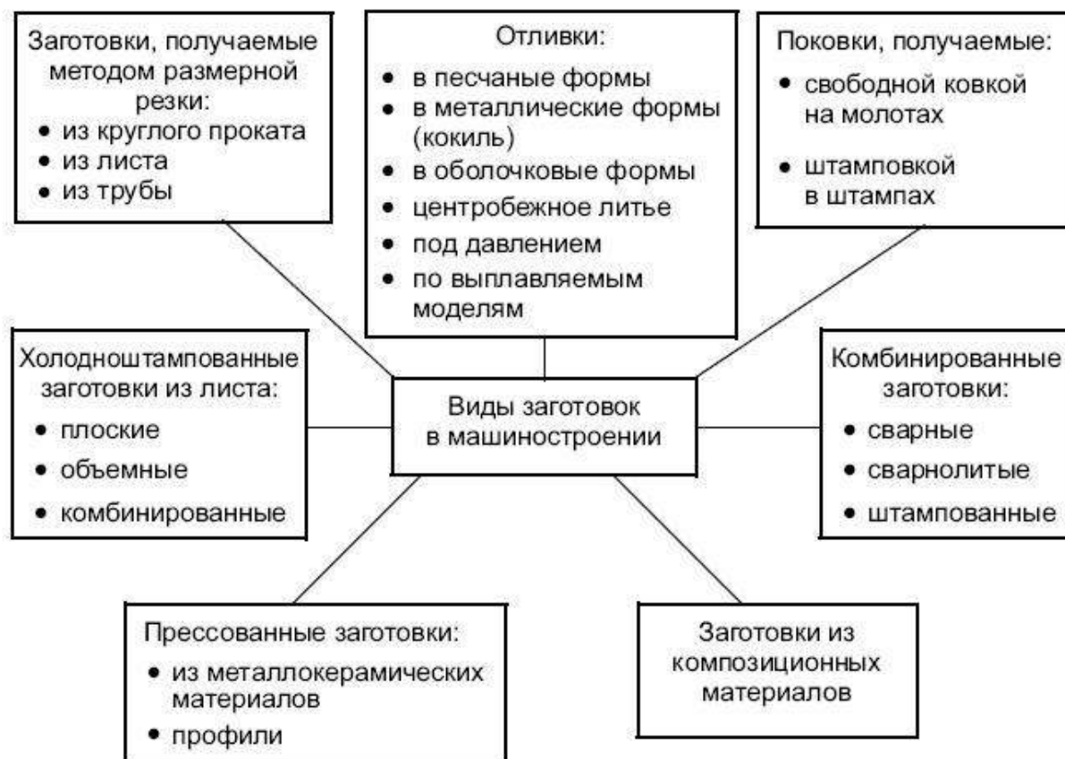
Обобщенная классификация заготовок, применяемых в машиностроении
