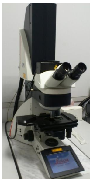
Рисунок 2.2—Оптический микроскоп «Leica DM 6000 M»
