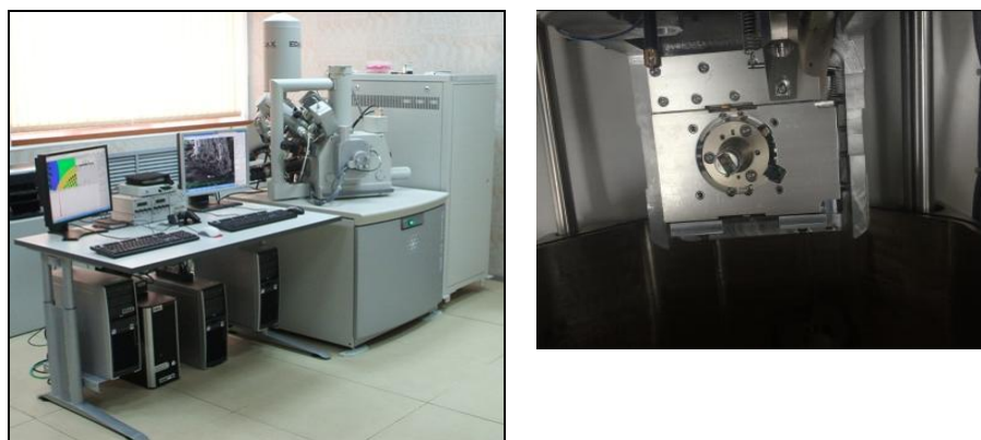
Рисунок 2.1 - Установка Quanta3D 200i (справа держатель образца)
