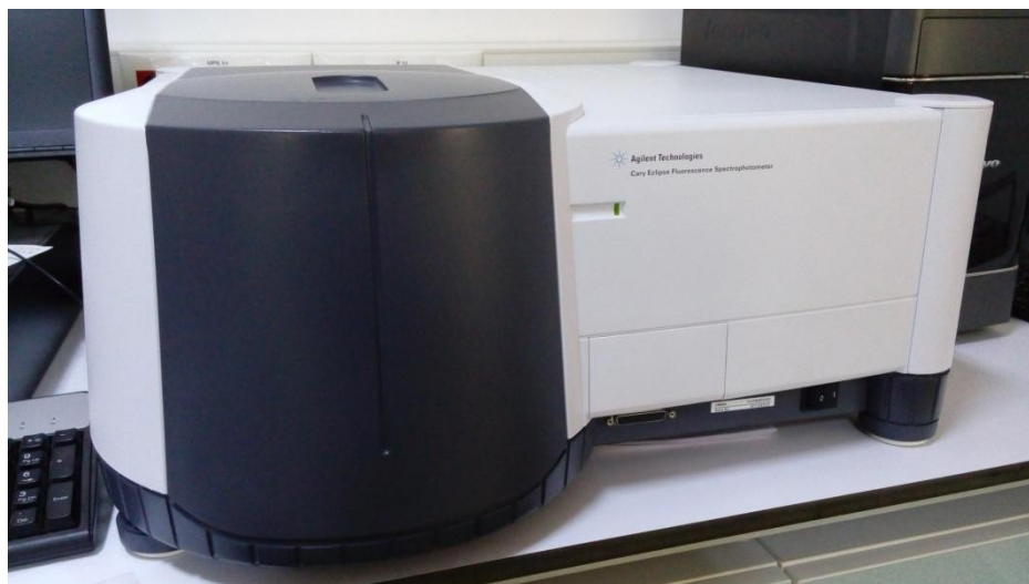
Рисунок 2.4 – Спектрофлуориметр CaryEclipse фирмы Agilent
