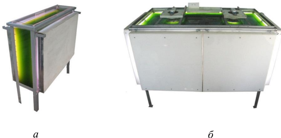
Рисунок 1.6 - Примеры биореакторов: а – Культиватор маточной культуры КМК-150, б - Фото-биореактор ФБР-150 [7]
