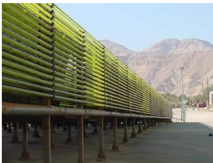
Рисунок 1.5 – Закрытая установка для выращивания хлореллы.
