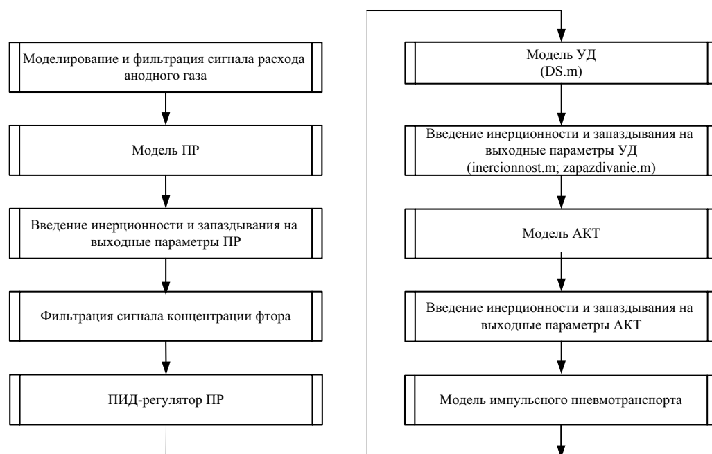
Рис. 5. Структурная схема модели производства гексафторида урана
