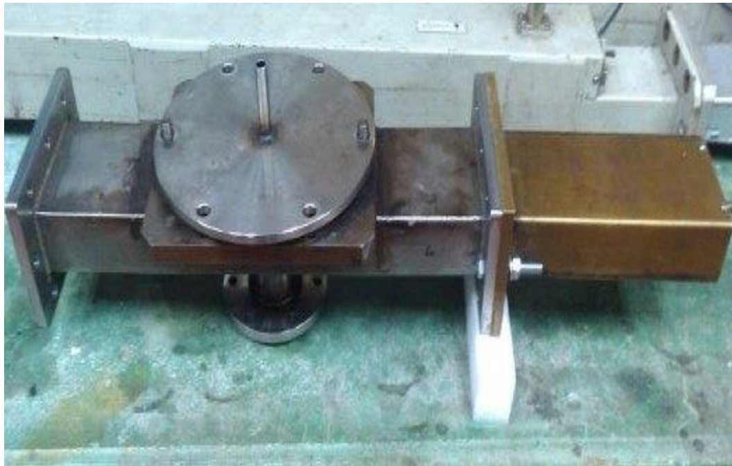
Рисунок 8 – Внешний вид волноводного СВЧ плазмотрона с короткозамыкающим поршнем
