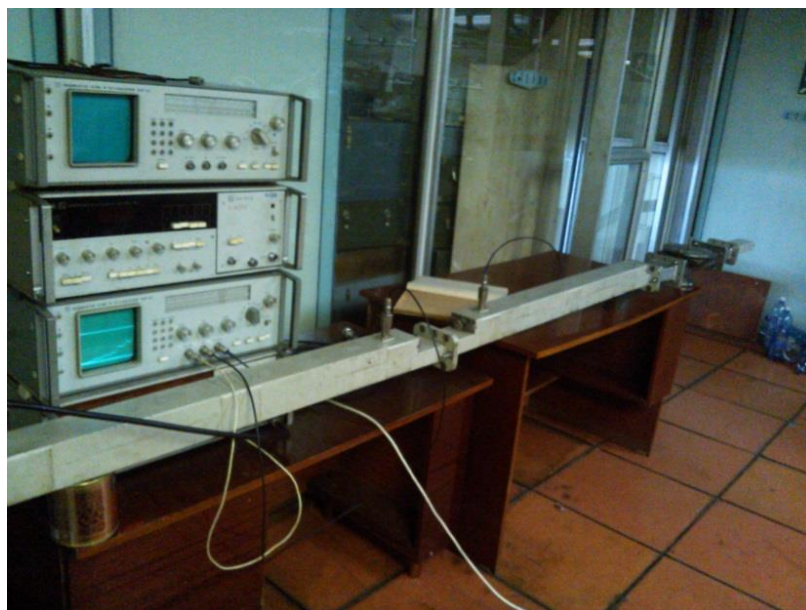
Рисунок 9 – Схема измерения КСВН
