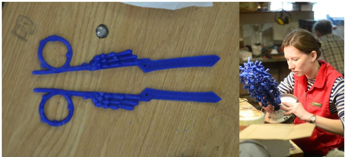
Рисунок 12. Изготовление восковок. Сборка елочки
