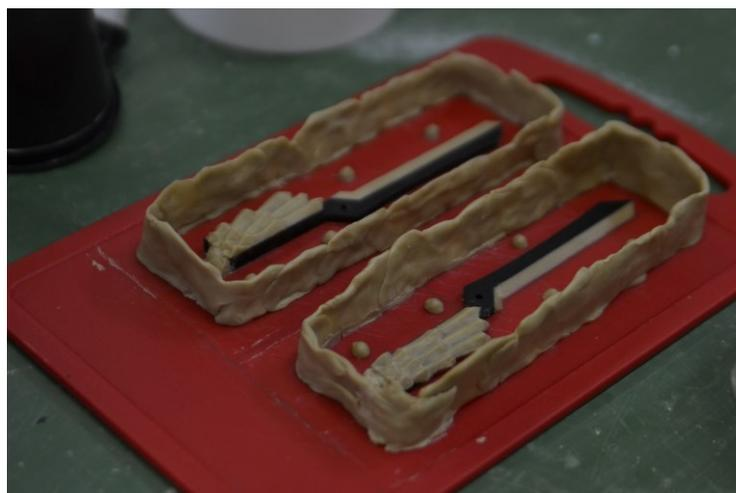
Рисунок 10. подготовка к заливке силикона
