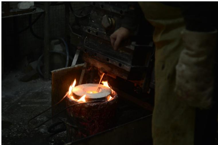
Рисунок 14. Заливка металла в форму
