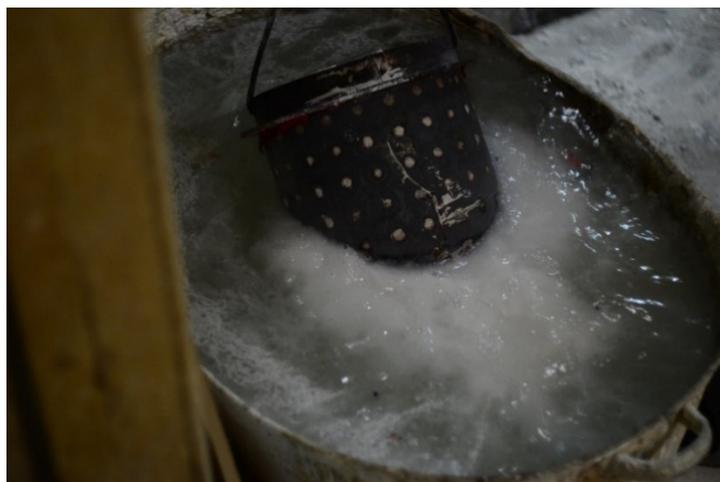
Рисунок 15. Охлаждение и промывка опоки
