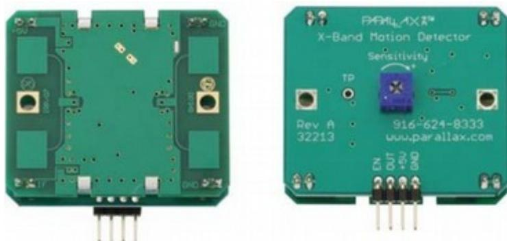
Рисунок 5 - Передняя и задняя панели X-Band motion detector
