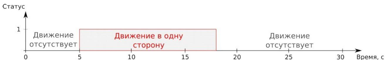
Рисунок 12 - Временная диаграмма процесса проведения эксперимента, движение вдоль зоны контроля
