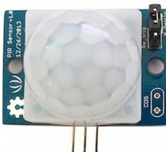
Рисунок 6 - Вид на фронтальную панель датчика PIR sensor
