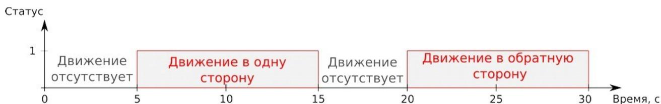
Рисунок 11 - Временная диаграмма процесса проведения эксперимента, движение поперек зоны контроля
