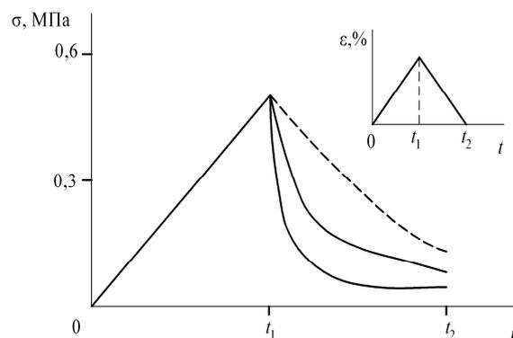
**Рис. 6.** Нагружение и разгрузка с постоянной скоростью деформирования ( $t_1 = 10$  мин.,  $t_2 = 2t_1$ ). ---- расчет по (4); — опыт; — расчет по (5)
