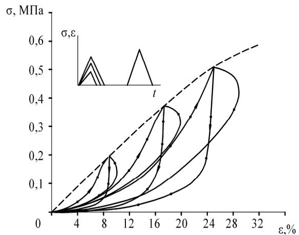
Рис. 2. Нагружение и разгрузка при  $\dot{\varepsilon} = \text{const}, \dot{\sigma} = \text{const}$ . ---- расчет по (4); — нагружение, опыт и расчет по (5); - - - разгрузка, опыт; — расчет по (5)
