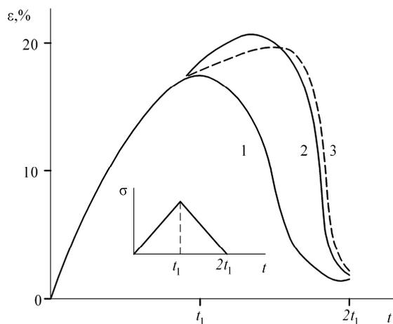
**Рис. 3.** Нагрузка и разгрузка с постоянной скоростью изменения напряжений ( $t_1 = 8$  мин). 1) расчет по (4); 2) опыт; 3) расчет по (5), (6)
