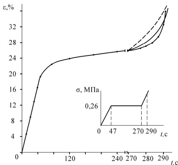
**Рис. 4.** Догрузка с постоянной скоростью изменения напряжений после ползучести. ---- расчет по (4); — опыт; — расчет по (6)
