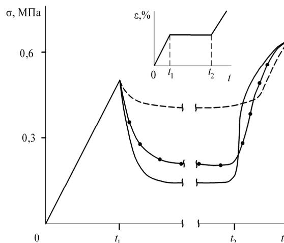
**Рис. 5.** Восстановление при нагружении с постоянной скоростью деформирования после релаксации напряжений ( $t_1 = 10$  мин.,  $t_2 \geq 10t_1$ ). ---- расчет по (4); — опыт; — расчет по (5)
