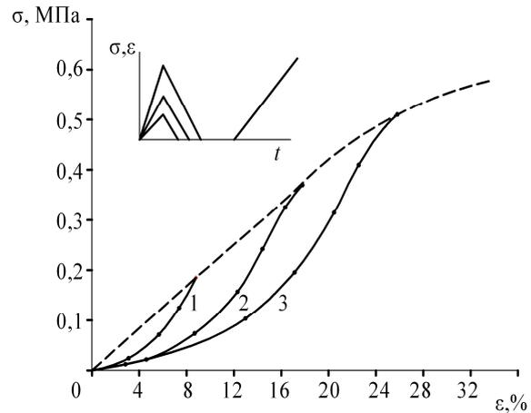
Рис. 1. Повторное нагружение НЭ после отдыха в режимах,  $\dot{\varepsilon} = \text{const}, \dot{\sigma} = \text{const}$ . ---- расчет по (4); — опыт, расчет по (5). Уровни предварительного нагружения для кривых (1), (2), (3) – 0,20, 0,38, 0,51 МПа
