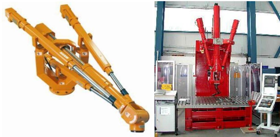
Рисунок 1.1.4. Промышленные роботы линейки Tricert
