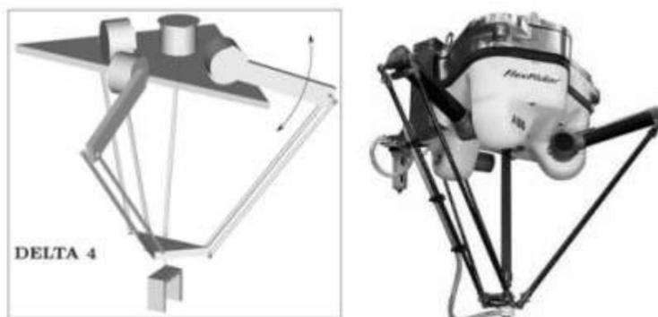
Рисунок 1.1.2. Дельта-робот и одна из его промышленных реализаций - FlexPicker IRB
