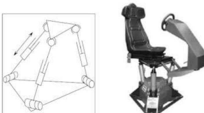
Рисунок 1.1.3. Предложенный Хантом и Ли 3-подвижный манипулятор и пример его применения в качестве развлекательного устройства
