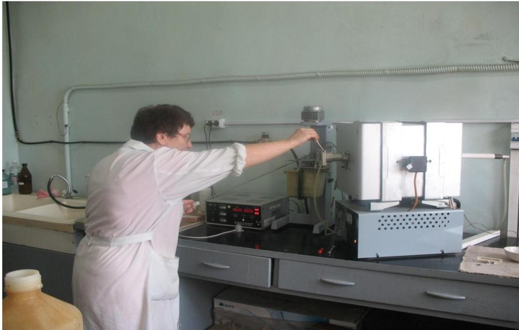
Рис. 28 - Определение pH и плотного остатка
