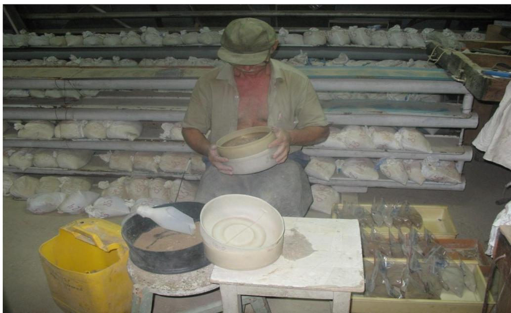
Рис. 27 – Пробоподготовка: квартование и просеивание
