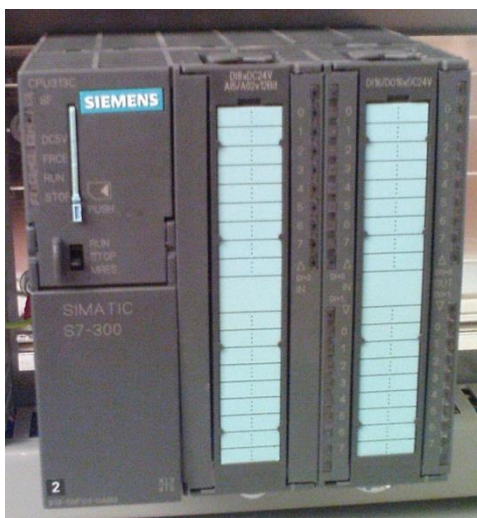
Рисунок 3- контроллер Siemens SIMATIC S7-300
