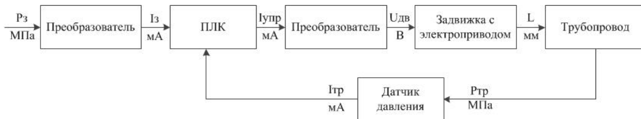
Рисунок 15- Функциональная схема системы поддержания давления
