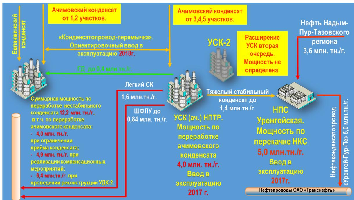
Рисунок 16 - Схема переработки и транспорта конденсата, после реализации инвестиционных проектов и компенсирующих мероприятий
