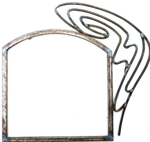
Рисунок 15. Приваренная к раме часть декоративной конструкции
