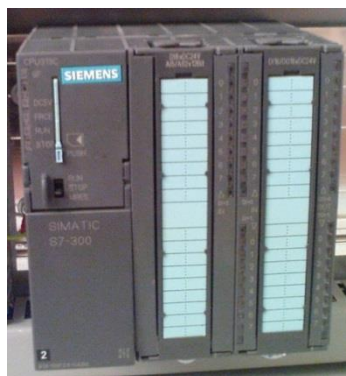
Рис. 9 – Внешний вид контролера Siemens SIMATIC S7-300
