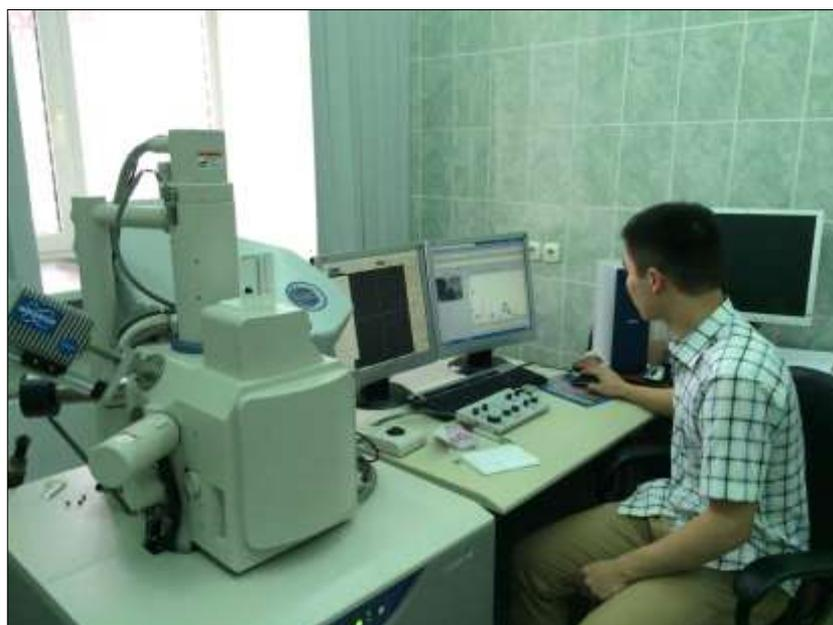
Рисунок – 4.2.4.1 Сканирующий электронный микроскоп Hitachi S-3400N
