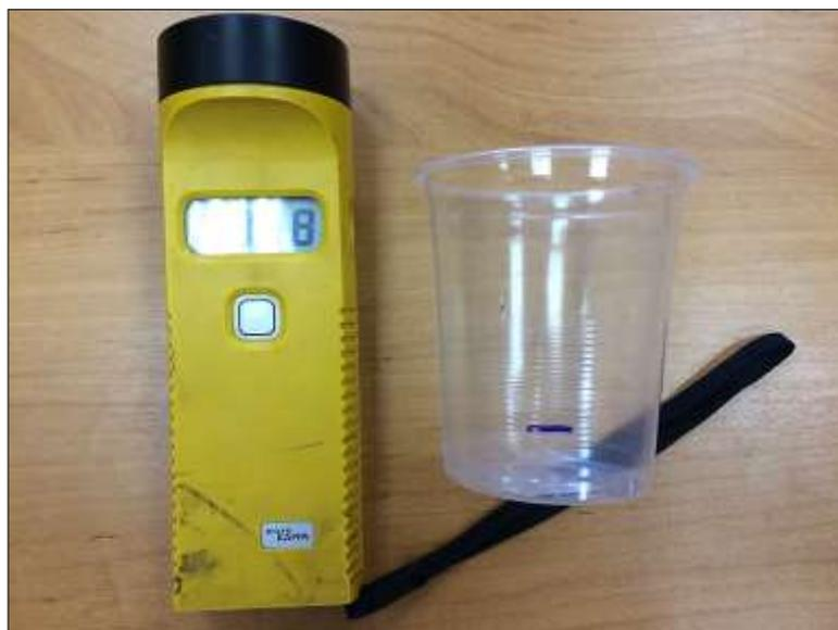
Рисунок – 4.2.2.1 Прибор Карраmeter Model КТ-5 и пластиковый стаканчик.
