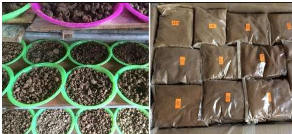
Рисунок – 4.1.7 Просушивания просеивания почвенных проб
