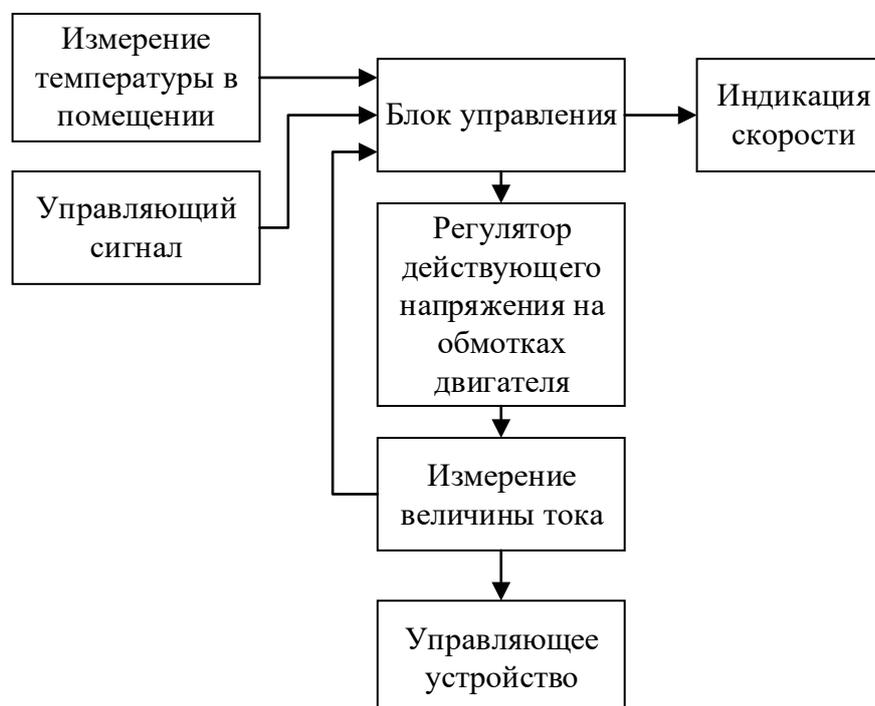
Рисунок 5. Функциональная схема
