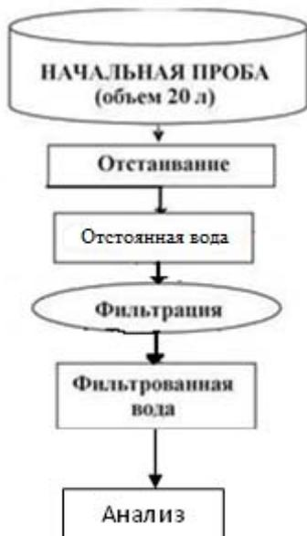
Рисунок 7 - Схема обработки и анализа водных проб
