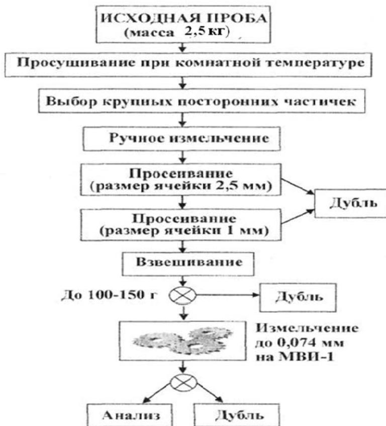
Схема обработки и изучения проб почв
