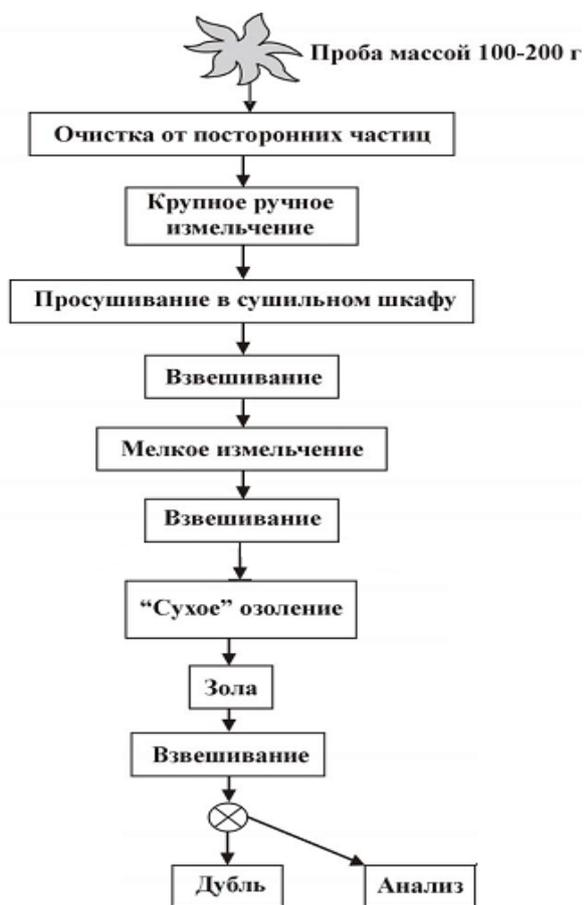
Рисунок 9 - Схема обработки и изучения проб растительности
