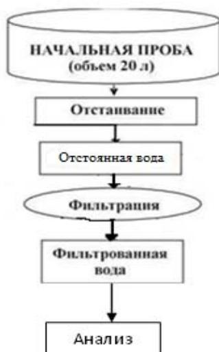
Рисунок 8 - Схема обработки и анализа водных проб
