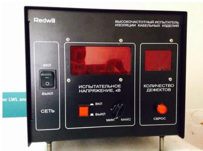
Рисунок 15 – Высокочастотный аппарат контроля изоляции
