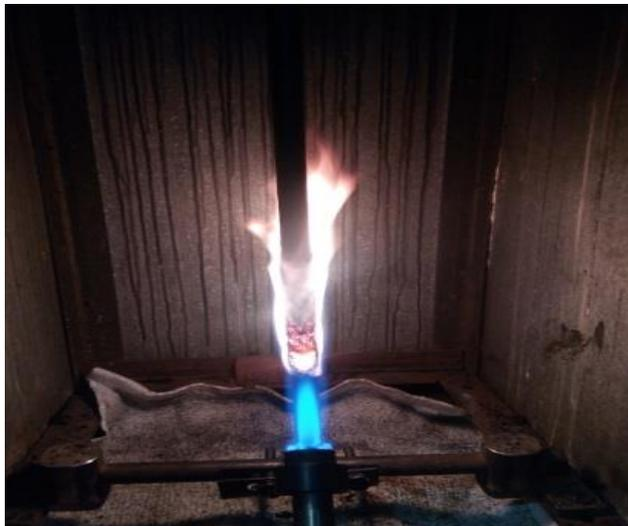
Рисунок 2.4 - Воздействие открытым огнем на кабель марки ВВГнг
