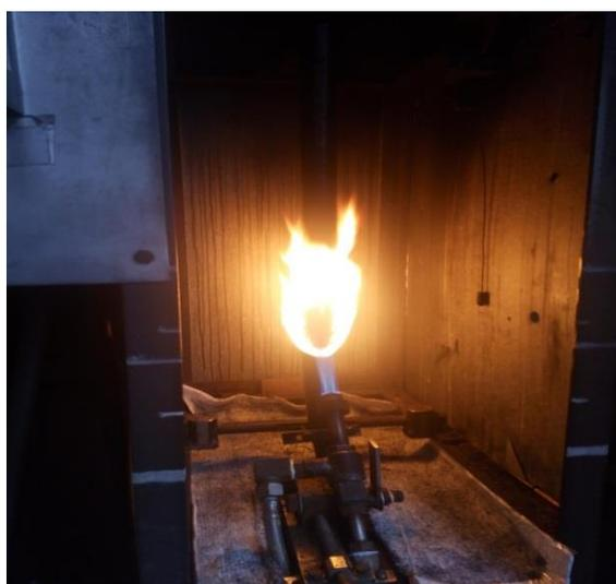
Рисунок 2.2 - Воздействие открытым огнем на кабель марки ВВГ
