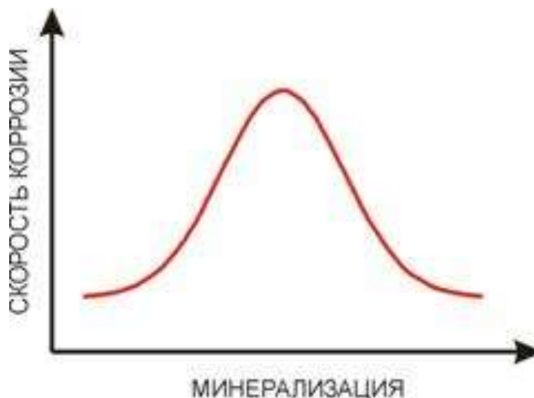
Рисунок 3.1.4.3 – Зависимость скорости коррозии от минерализации воды
