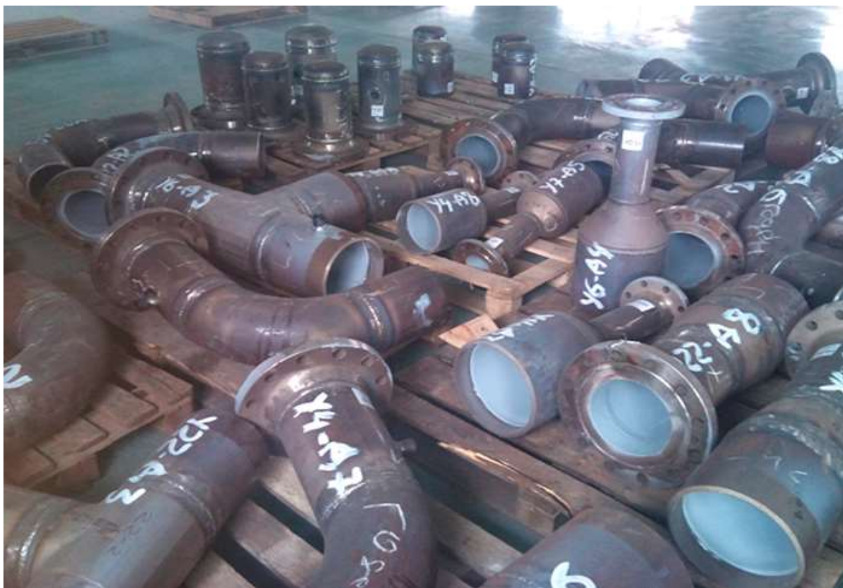
Рисунок 5.2.2.2– Фасонные соединительные детали с внутренним антикоррозийным покрытием
