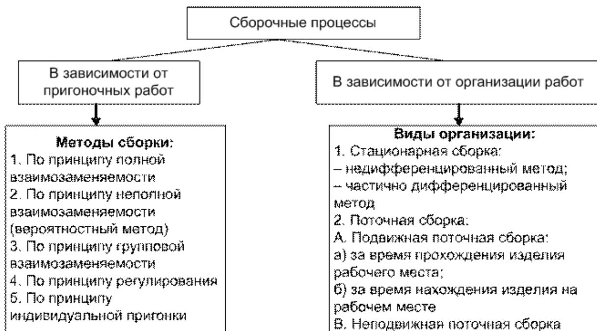
Рисунок 3.2 – Классификация сборочных процессов
