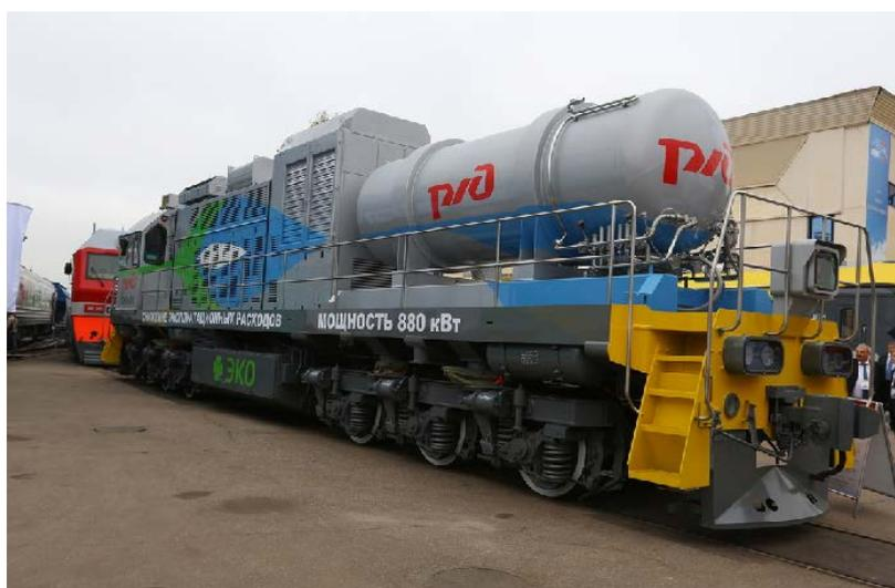
Рис. 11 Маневровый газопоршневой тепловоз ТЭМ19
