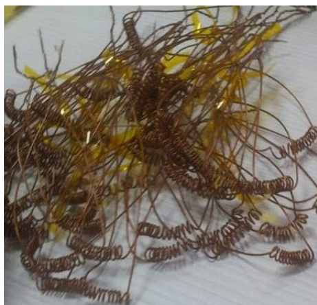
Рисунок 2.7 – Общий вид образцов для испытаний на кратковременную прочность
