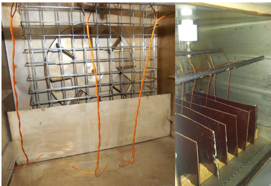
Рисунок 3.3 – Общий вид образцов помещенных в термокамеру
