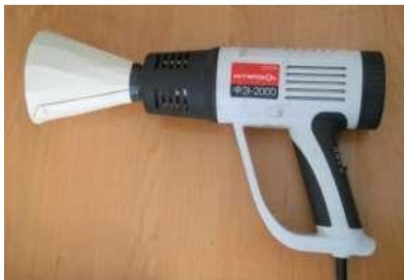
Рисунок 3.6 – Термопистолет с насадкой
