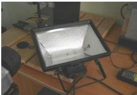
Рисунок 3.11 – Галогенная лампа мощностью 500 Вт с отражателем
