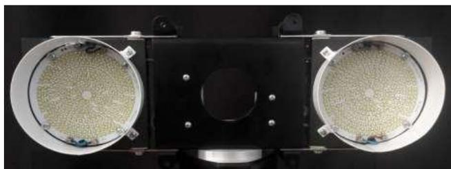
Рисунок. 4.1. Светодиодный источник нагрева мощностью 2×500 Вт.
