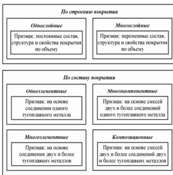
Рисунок 1.1 Классификация износостойких покрытий для режущего инструмента [1]
