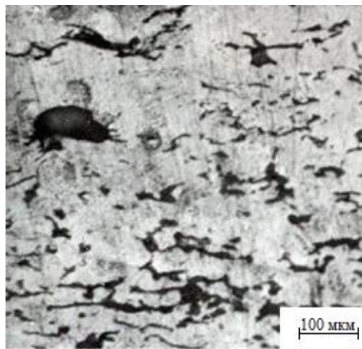
Рис.3.16 Микроструктура сплава №1: а) исходное состояние; б) деформированное состояние при T=20\text{ }^{\circ}\text{C} ; с) деформированное состояние при T=600\text{ }^{\circ}\text{C} ;
