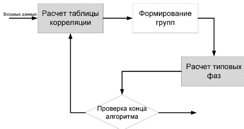
Рис. 7. Распараллеливание этапа расчета фазовой группировки
