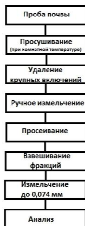
Рисунок 3.1.2 – Пробоподготовка проб почвы [37]
