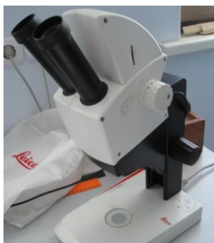
Рисунок 3.2.1 – Бинокулярный стереоскопический микроскоп Leica ZN 4D кафедры ГЭГХ
