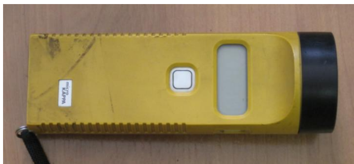
Рисунок 3.2.6 – Полевой измеритель магнитной восприимчивости кафедры ГЭГХ
