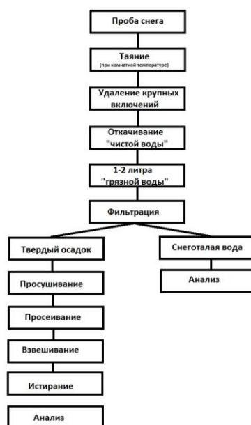
Рисунок 3.1.1 – Пробоподготовка проб снегового покрова [37]
