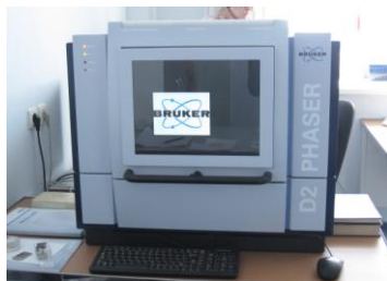
Рисунок 3.2.2 – Настольный дифрактометр D2 PHASER кафедры ГЭГХ
