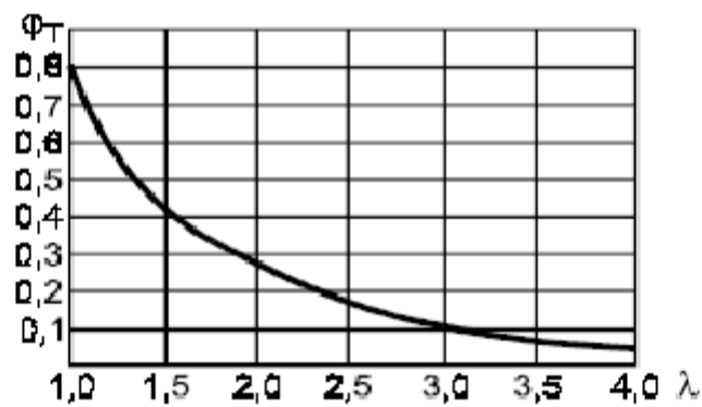
Рисунок - 10. Коэффициент уменьшения допускаемого напряжения при продольном изгибе
