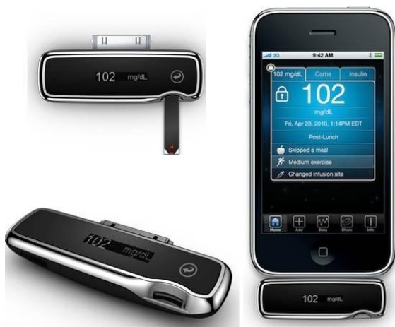
Рисунок 1.3 Портативный датчик для измерения уровня глюкозы в крови
