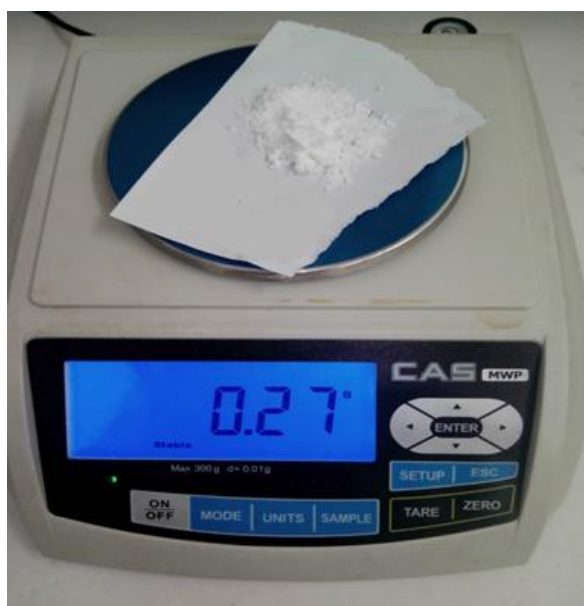
Рисунок 2.1 – Навеска карбоната аммония на электронных весах
