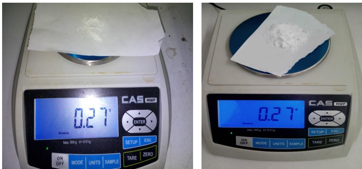
Рисунок 3.8 – Навеска карбоната аммония из вакуумного пакета и атмосферы
