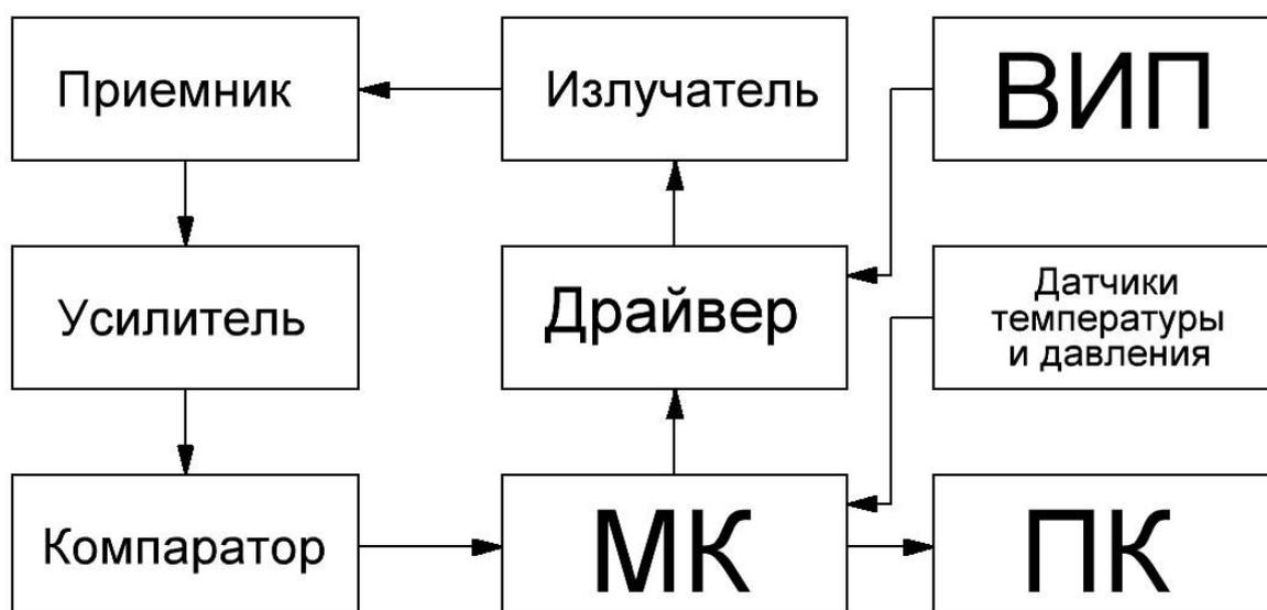
Рис.2.2 Структурная схема измерителя толщины льда
