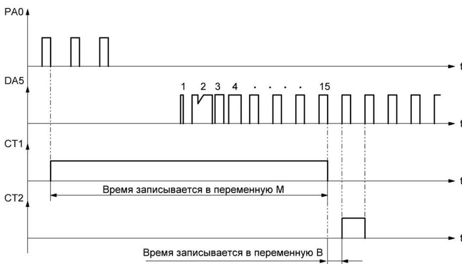
Рис.3.5 Диаграммы срабатываний таймеров
